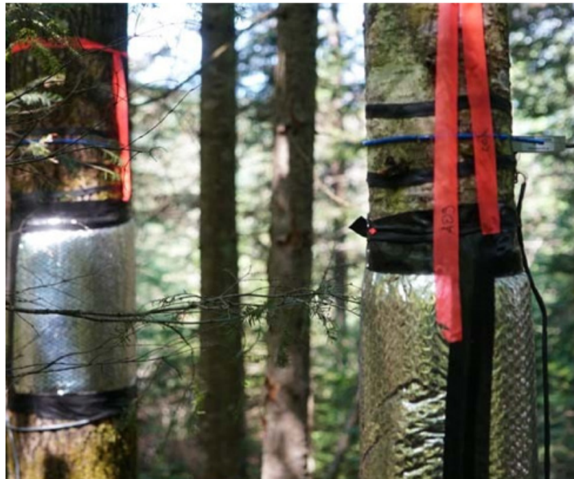
Figure 3. Capteurs du flux de la sève et dendromètres. Site de recherche de SMARTFORESTS CANADA, Sainte-Émèlie-de-l'Énergie, Québec, juillet 2020. Crédit : Gisèle Trudel.
