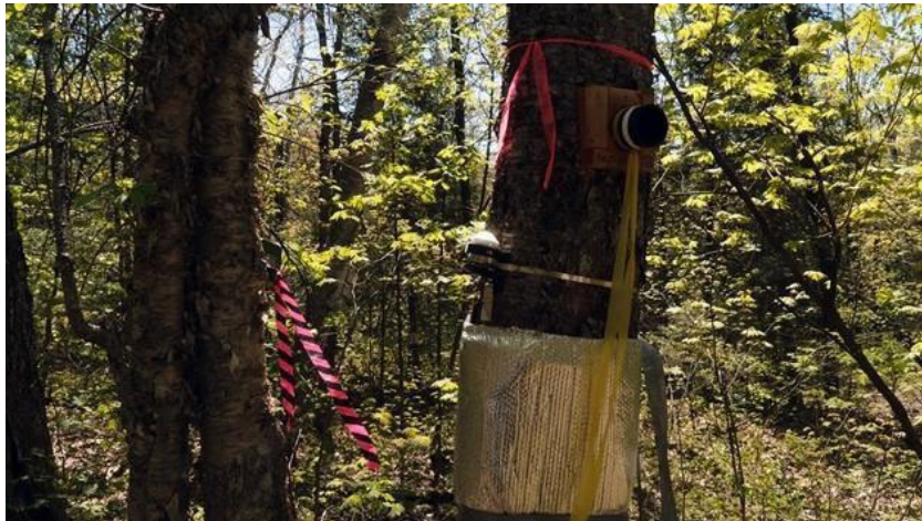
Figure 2. Capteur du flux de la sève, capteur de carbone et le dendromètre. Site de recherche du professeur et écologiste forestier Nicolas Bélanger à la Station de biologie des Laurentides, Saint-Hippolyte, Québec, mai 2021. Crédit : Gisèle Trudel.
