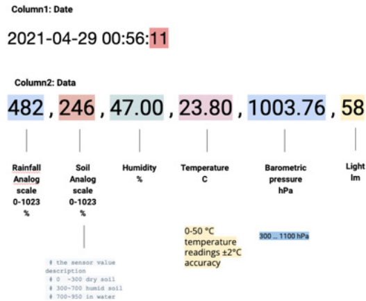
Figure 12. Capture d'écran des éléments de code informatique liés aux divers capteurs du kit artisanal météo. Conception et fabrication par Natalia Balska et Archie Reid, mai 2021.
