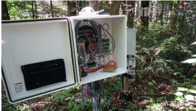
Figure 1. Système informatique servant à la collecte des données chiffrées en provenance des capteurs. Site de recherche de SMARTFORESTS CANADA, Sainte-Émélie-de-l'Énergie, Québec, juillet 2020. Crédit : Gisèle Trudel.
